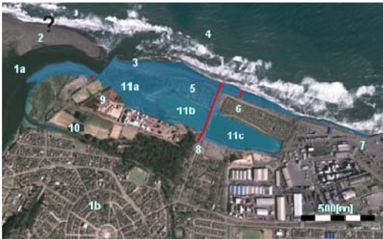
Figura 3: Estimación del área de inundación por el tsunami 2010. Desembocadura río Maipo (1a), Llolleo (1b), barra de arena (2), botadero (3), pluma del río (4), cabañas arrasadas (5), cabañas sector norte (6), área de servicio del puerto (7), avenida La Playa correspondiente al sector de mayor penetración (8), astilladora (9), parque de deporte y recreación (10), lagunas costeras (11a, b y c).
